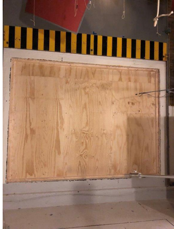
Figur 3: Isotimbervägg monterad i öppningen, sedd från mottagarrummet.
