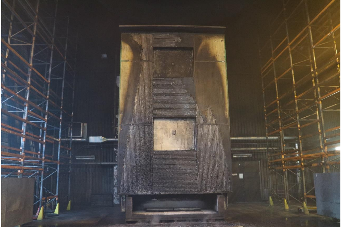
Skadebilden efter att provobjektet har släktts med vatten.
