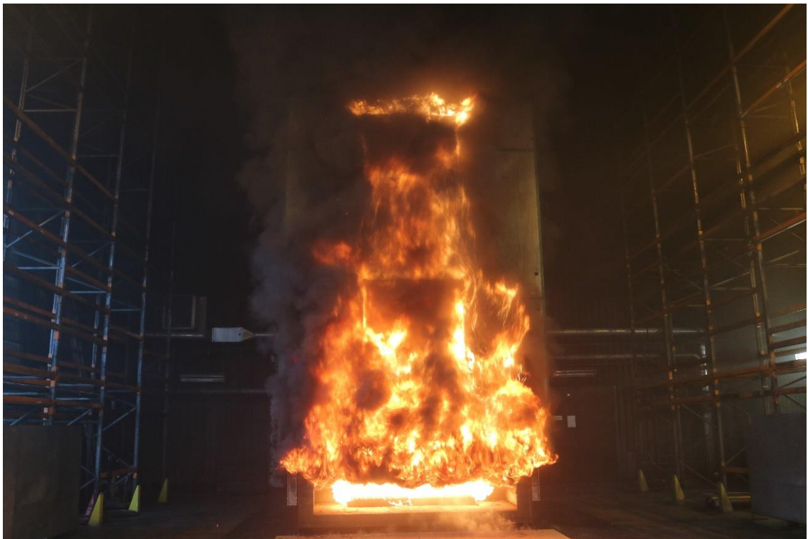
Provobjektet under brandprovet.
