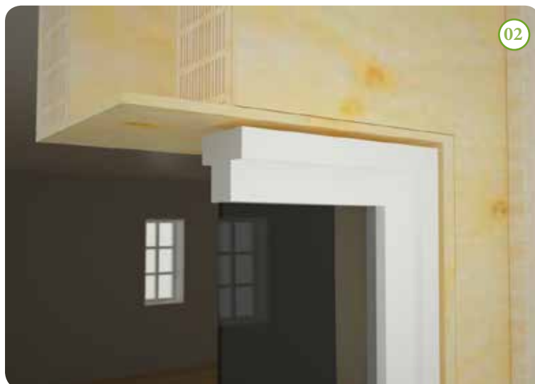
Kanterna i fönsteruttaget kläs med plywood och ger en flexibel och bra infästning oavsett var man vill placera fönstret.
