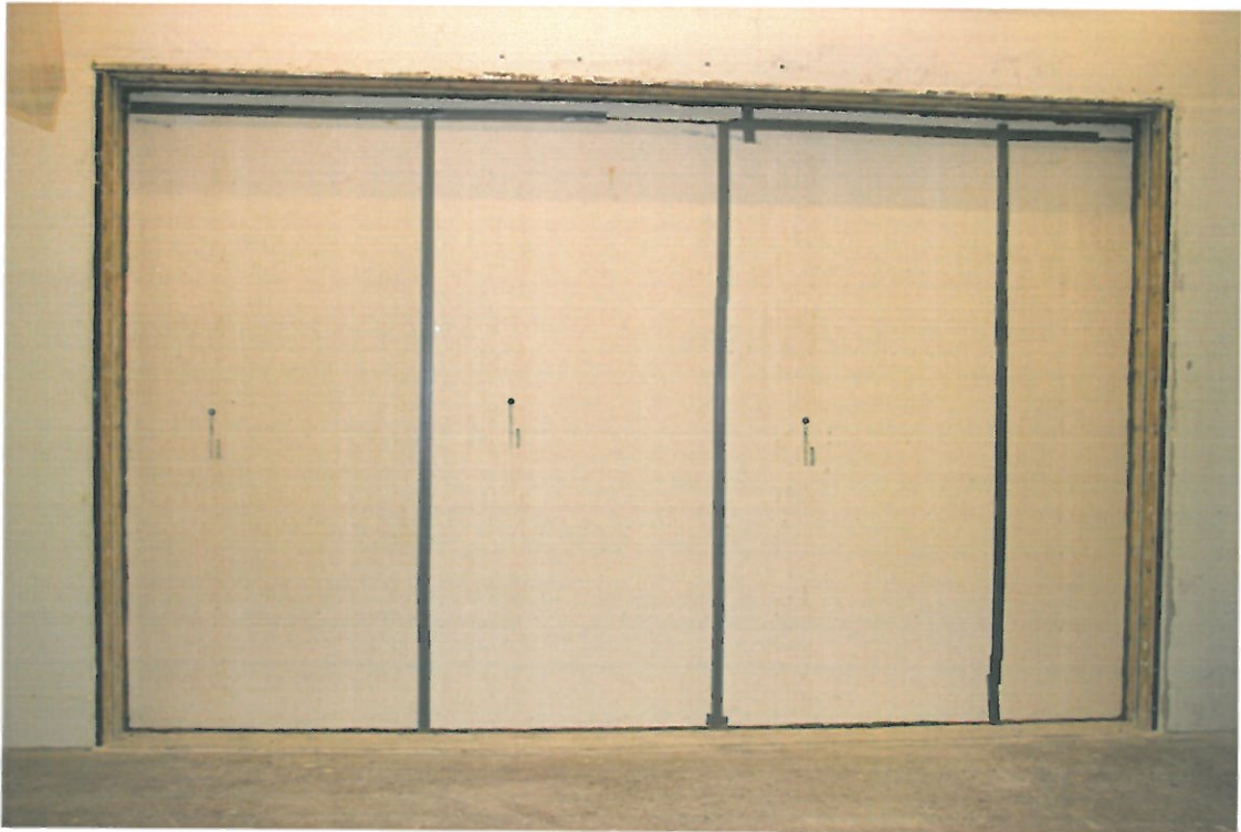
Bild 7 – Skivorna tätades med modellera och tejp. Metoden används för konstruktionerna i samtliga bilagor.
