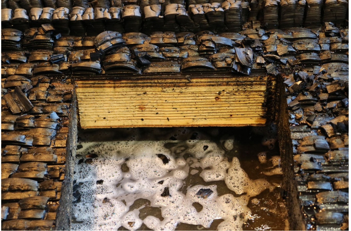
Genomskärning i centrum av provföremålet direkt efter avslutat prov.
