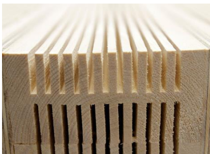
Bild 1: Struktur på spårad träregel.
